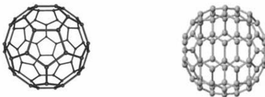
Εικόνα 2.4-1: (α) Φουλερένιο C-60 με 60 άτομα άνθρακα (β) Φουλερένιο C-70[58]
